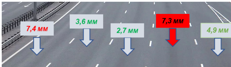
Результаты измерения колейности на участке ЩМА-16 сера (06.10.2021)
