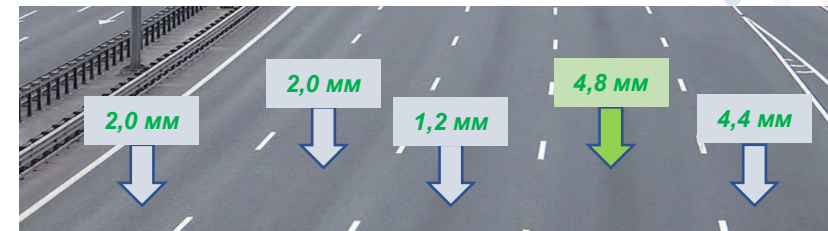
Результаты измерения колейности на участке ЩМА-22 (06.10.2021)
