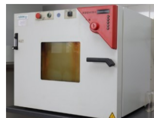
Краткосрочное старение в RTFOT. Моделирование состояния на момент начала эксплуатации.
