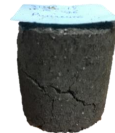
Образец после определения предела прочности на сжатие
